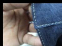
Кнопочный переключатель A или B может использоваться для управления функцией полу-стежка во время шитья. Например, эта функция необходима при выполнении угловой строчки на джинсах для сохранения длины стежка на углах. Таким образом, при использовании машины S-7300A за счет автоматизации ручной операции снижается нагрузка оператора.
