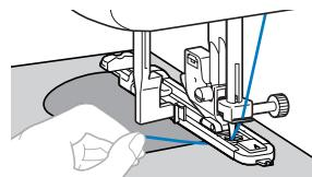
► По завершении шитья машина автоматически прошивает усиливательные стежки, а затем останавливается.
