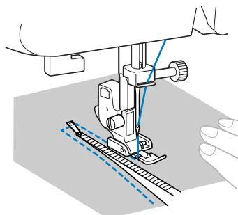
5 Для пришивания противоположной стороны застежки «молния» отсоедините лапку, нажав кнопку, расположенную на задней части прижимной лапки, расположите лапку на другой стороне застежки «молния» и продолжите шитье, используя паз на другой стороне.
