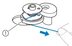
① Прорезь в седле устройства намотки шпульки (со встроенным устройством обрезки)
