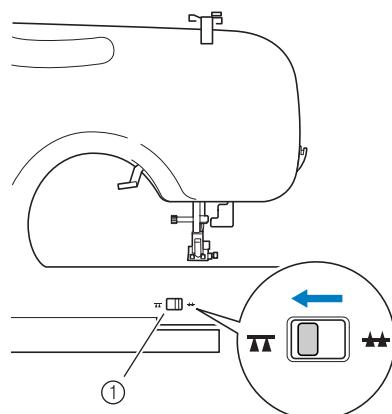
① Рычаг положения гребенок транспортера (вид с задней стороны машины)
