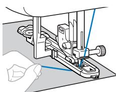
► По завершении шитья машина автоматически прошивает усиительные стежки, а затем останавливается.
