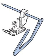
**2** Отрегулируйте положение направляющей таким образом, чтобы она совпадала с уже прошитым швом.
