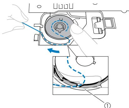
① Пружина регулировки натяжения нити
