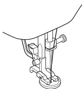
8 Снимите материал с машины. Обрежьте верхнюю и нижнюю нити и свяжите их на изнаночной стороне ткани.
