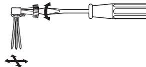
5 Поверните иглу плоской частью к задней стороне машины и вставьте ее до упора.
