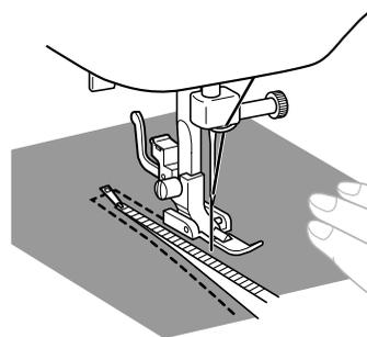
5 Чтобы прошить противоположную сторону застёжки, освободите лапку, подняв рычаг, расположенный на задней стороне лапки, переставьте лапку на другую сторону застёжки и продолжайте шить, используя другую прорезь.
