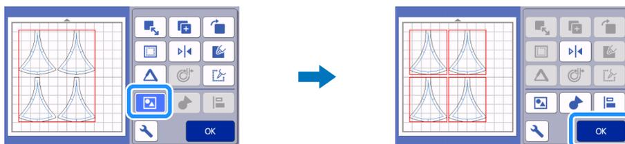
**10** С помощью функции автоматической компоновки на экране компоновки мата расположите рисунки и нажмите кнопку "OK".
